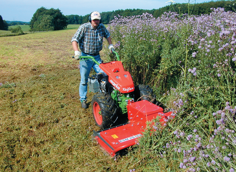
Extenzivní sečení louky nosičem nářadí Agria 5900 Taifun a vertikálním mulčovačem ESM o pracovním záběru 122 cm
