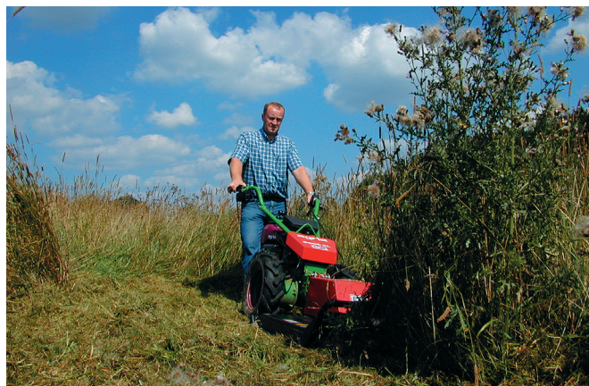
Extenzivní sečení s jednoosým patentovaným mulčovačem ESM VS80 Verti-2-Flail o záběru 80cm. Nosič Agria 5500 KL
